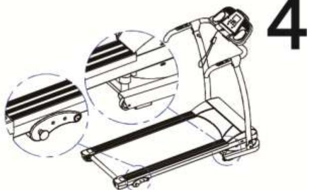
1. Вытащите 4 коротких винта и прокладки из упаковки с крепежом, закрепите левую и правую стойки на основной раме с помощью винтов. Не затягивайте винты до окончания сборки.
