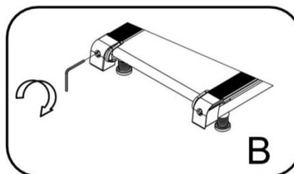
3. Регулярно настраивайте оптимальное натяжение беговой ленты. Снимите крышку и поверните левый и правый регулировочный болт на 1/4 оборота по часовой стрелке. Затем попробуйте пробежаться. Если лента все еще слишком слабо натянута, продолжайте настройку. **Рисунок С**
