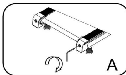
2. Если лента смещена влево, снимите крышку и поверните левый регулировочный болт на 1/4 оборота по часовой стрелке. Затем попробуйте пробежаться. Если лента все еще смещена, продолжайте настройку. **Рисунок В**
